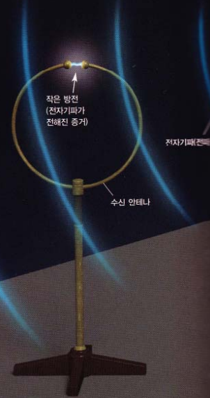
* 실제로 전자기파는 방전이 있거나 없는 곳에서 모든 방향으로 퍼져 나간다. 여기에서는 수신 안테나로 향하는 전자기파만을 그렸다.
